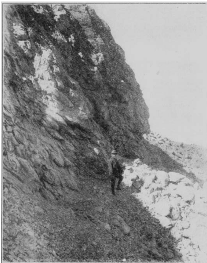
Abb. 8. Kupferberg von Chuquicamata. Frisch gesprengte Wand in kupferhaltigem Granodiorit.
