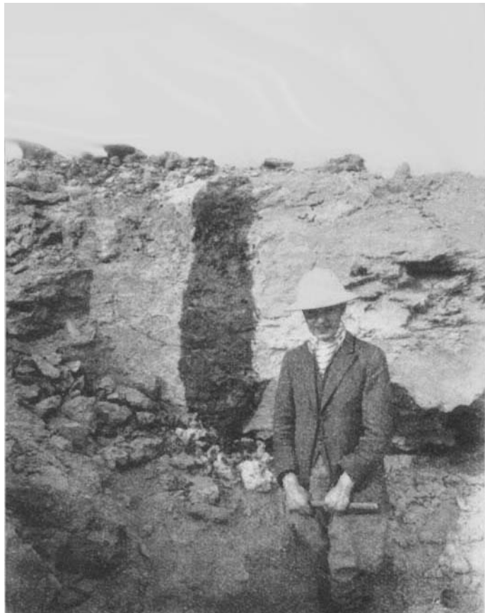
Abb. 3. Salpeter-Tagebau in den Feldern von Prosperidad, Toco. Mehrere kompakte Salzschuttbänke übereinander. (Ein Profilstreifen ist künstlich befeuchtet, um zu zeigen, wie dunkel die Schuttgesteine unter humidem Klima erscheinen würden.)
